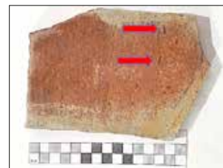
Abb. 4 Schnitt durch eine Rhyolithsäule vom Kahlbusch mit Fiammen (Pfeile) und randlichen Bleichungszonen (Foto Kathrin Penndorf, HMD)
