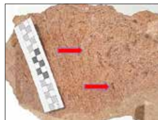
Abb. 5 auf der Bruchfläche erkennbare Fiamme und „Fließstrukturen“ (Foto Kathrin Penndorf, HMD)
